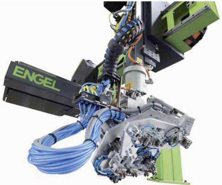
Mit der Software *multidynamic* passen die Engel viper-Roboter die Geschwindigkeit und Beschleunigung ihrer Bewegungen an die aktuelle Belastung an und erreichen so eine höhere Dynamik. Neu ist, dass nicht nur die Geschwindigkeit entlang der Linearachse, sondern auch die der Drehachsen belastungsabhängig optimiert wird.
