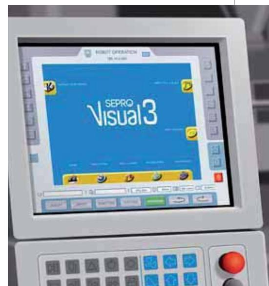
Open Integration von *Sepro* ermöglicht die Spiegelung des Robotersteuerungsbildschirms auf der HMI-Spritzgießmaschine. Fotos: *Sepro*
