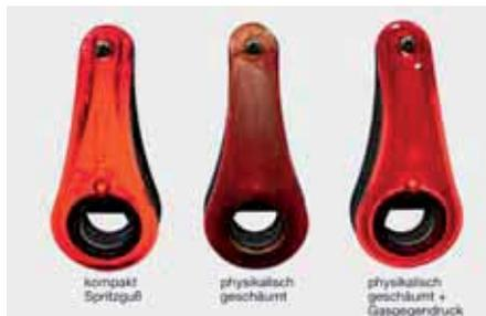
Mit *Somos Perfoamer* und einer Engel e-victory 310/80-Spritzgießmaschine schäumt ProTec Flaschenöffner live auf der Fakuma.
