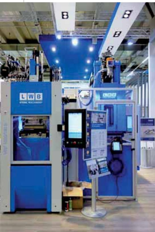
LWB-Steinl präsentiert auf der Fakuma eine verkettete Produktionszelle, in der eine C-Rahmen-Maschine VCRS 500/115 mit Thermoplast-Spritzeinheit mit einer Gummi-Spritzgießmaschine VRF 1100/160 Portalrahmen zusammenarbeitet.
