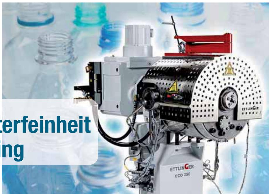
Im Mittelpunkt des *Fakuma*-Auftritts von *Ettlinger* stehen Schmelzfilter, die besonders hohe Anforderungen an Kontinuität und Produktqualität erfüllen. Dazu bietet die jetzt für die *ECO*-Baureihe verfügbare, noch weiter gesteigerte Filterfeinheit von 60 µm ideale Voraussetzungen für den Einsatz von 100-%-PET-Bottle-Flakes in Tiefziehfolien, Verpackungsband- und Spinnfaseranlagen.
