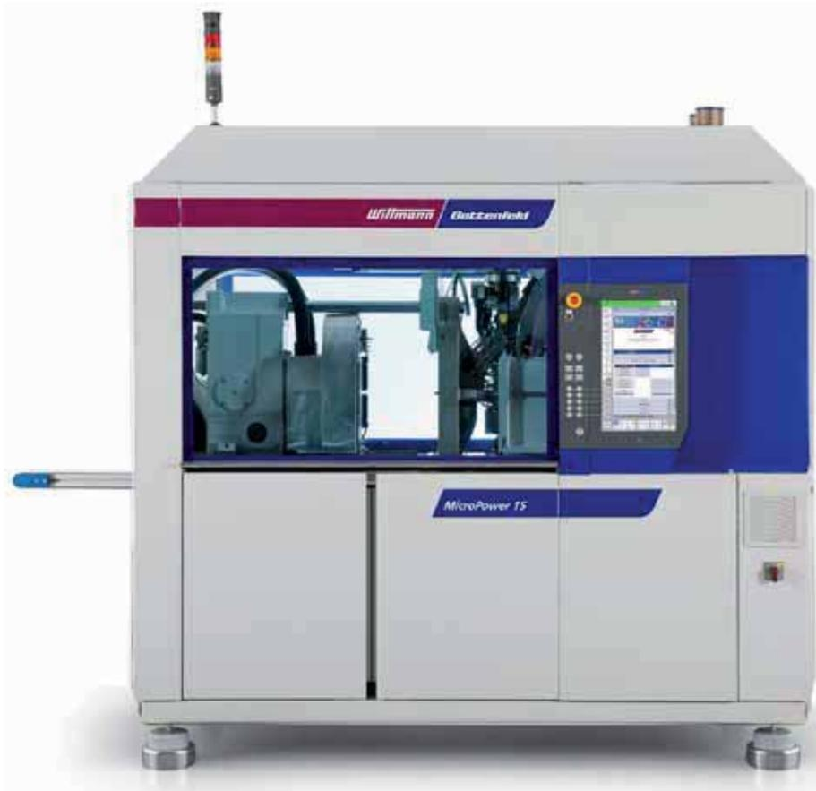
Auf einer *MicroPower 15/10 H/10H Combimould* wird mit einem 4-fach-Werkzeug der Firma *Wittner* aus Österreich eine hauchdünne aus PP und EVA9 sphärisch-geformte Membran, produziert, die zum Messen eines spezifischen Druckes innerhalb eines Messgerätes dient.
