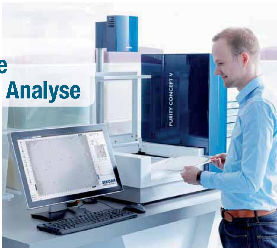
Das *Purity Concept V* zur optischen offline Inspektion und Analyse von Kunststoffmaterialien feiert auf der *Fakuma* Premiere. Durch die Auswertung der Bildaufnahmen werden Verunreinigungen, wie „Black Specks“ innerhalb von transparenten Pellets sowie auf der Oberfläche von opakem und farbigem Material automatisch detektiert, visualisiert und ausgewertet. Foto: Sikora
