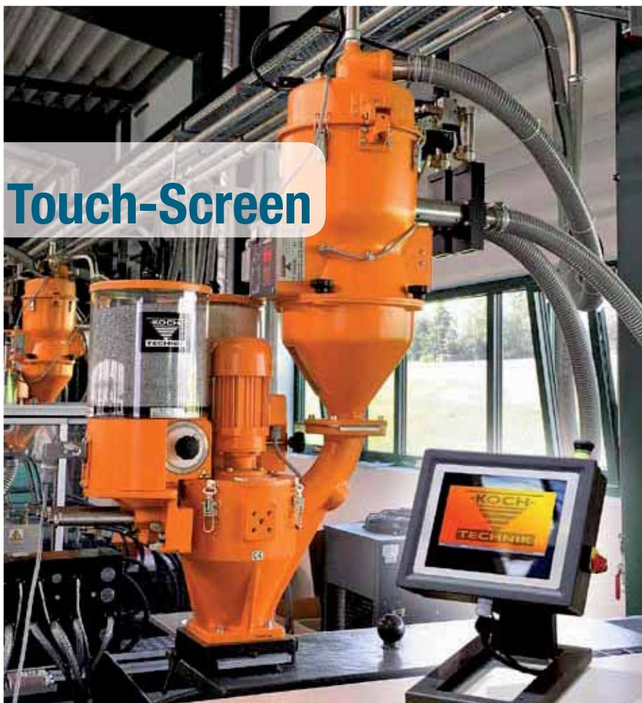
Das neue Steuergerät MC 7 von Koch-Technik dient zur genauen Zudosierung von Masterbatch oder Pulver zu Kunststoff-Rohmaterial vor der Verarbeitung im Spritzguss oder Extrusion.
