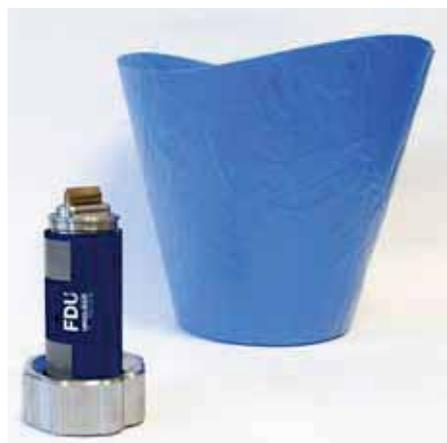
Die FDU-Heißkanaldüsen kombinieren die Möglichkeiten der Extrusion und der konventionellen Düsen mit Punktanschnitt. Der wesentliche Vorteil ist die größere Durchsatzmenge pro Zeiteinheit, wodurch Einspritzzeiten deutlich verkürzt werden können, ohne dass wesentliche Abstriche bei der Anschnittqualität akzeptiert werden müssen.
